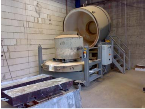
Unidad de procesamiento de 1,500 kg/proceso de quemado
