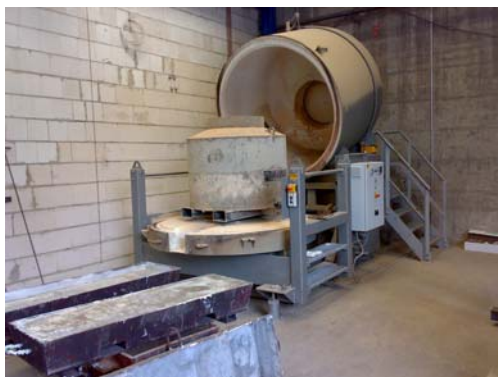
Unidade de processamento de 1500kg/queima
